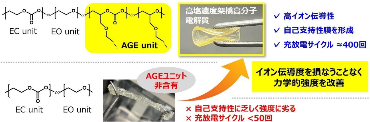
図2：架橋構造の制御と超高塩濃度化の組み合わせによりイオン伝導性と力学的強度の両立を実現。
