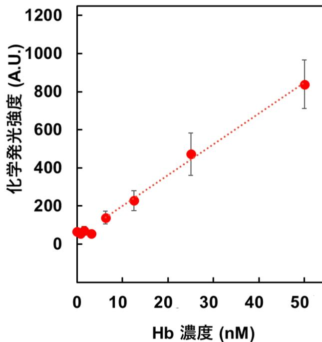
図2 化学発光による血清中 Hb の検出結果。Hb 濃度依存的な化学発光の増加が確認されました。
